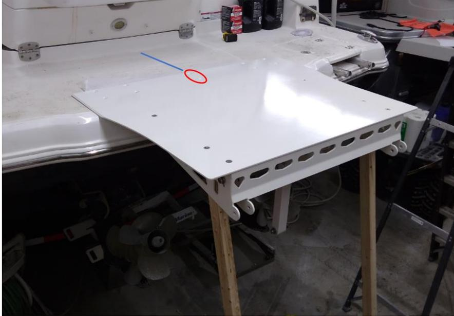
Afin de maintenir la plaque d'extension (20) en place, il est recommandé d'insérer des montants temporaires dans le châssis (10). L'angle de la plaque d'extension peut être ajusté au besoin en déplaçant les montants.
