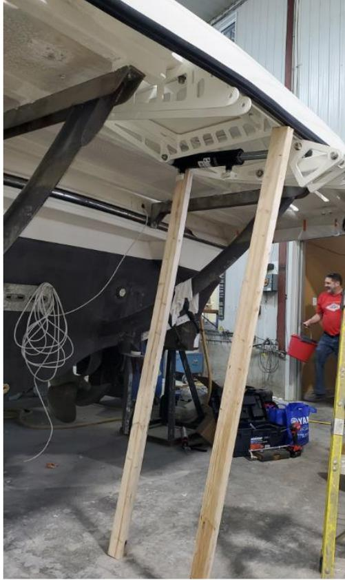
Les trous de pivot présents sur le châssis (10) doivent être alignés avec le rebord arrière de la plateforme de baignade afin de permettre à la plateforme pivotante (11) de bien se refermer.
