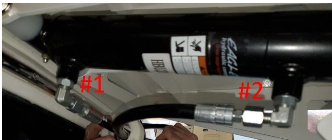
Il est possible de pivoter le connecteur #1 à 90° en dévissant l'écrou de blocage. **Toujours dévisser le connecteur afin de le placer à l'angle désiré.**
